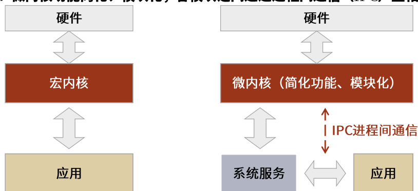
图表 7：微内核功能简化、模块化，各模块之间通过进程间通信（IPC）互相联系
